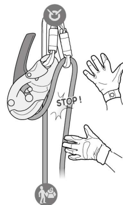
11c. Stop position Position d'arrêt
